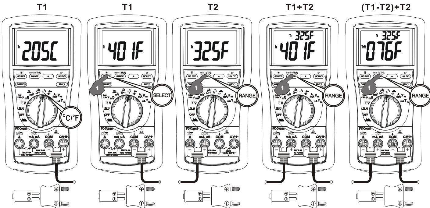
**(RANGE)** knappen momentvis for at aflæse **T1, T2, T1+T2 eller T1-T2+T2**. Sidst valgte aflæsning vil blive gemt i hukommelsen. **Note!** Vær opmærksom på, at temperaturføleren med bananstik er isat korrekt – rette polaritet. Man kan også bruge en såkaldt temperaturadapter, som omformer fra bananstik til type-k stik.
