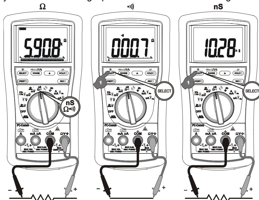
**ADVARSEL!** Ved brugen af gennemgangstest og modstandstest i et spændingsførende system, kan dette give fejlresultater og i værste fald ødelægge instrumentet. I mange tilfælde må den formodedt komponent frakobles fra systemet, for at man kan opnå en præcis måling.
